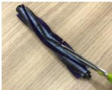
②回転ブラシまわりに絡まったゴミをはさみで切って取り除く。
